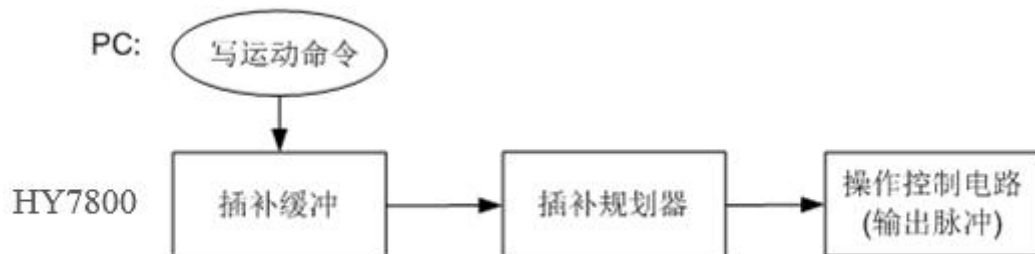
图2-19 多级缓冲寄存器连续插补的工作原理
